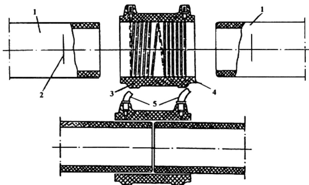
1 - труба; 2 - метка посадки муфты и механической обработки поверхности трубы; 3 - муфта;
