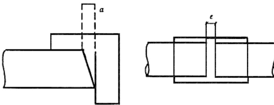
Рисунок 7 - Установка зазора при стыковке труб
