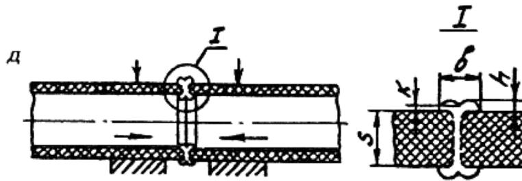
а - центровка и закрепление в зажимах сварочной машины концов свариваемых труб;
